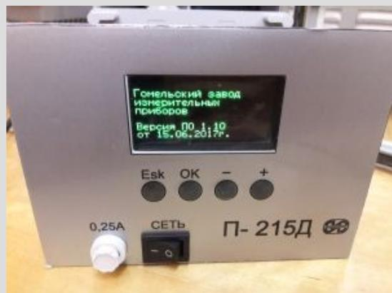
*Опытный образец преобразователя промышленного двухканального П-215Д*
