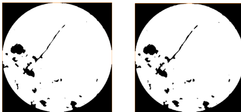
Рис. 3. Сегментированное (бинарное) изображение методом порогового значения (слева) и водораздела (справа). Белым цветом выделена твердая фаза, черным цветом – пустотное пространство и задний фон
