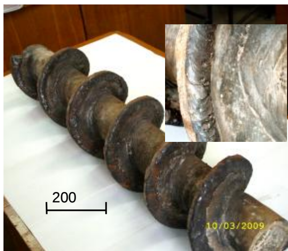
Шнек пневмовинтового насоса для подачи извести с восстановленными рабочими поверхностями
