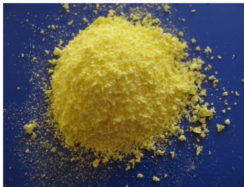
Порошок иттрий-алюминиевого граната, легированного ионами церия
