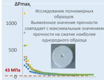
1000 2000 3000 4000 Результаты исследований с использованием статистически опосредованной выборки образцов выявили равномерное распределение в диапазоне 17 - 41 MΠa.
