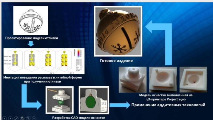
Технологический цикл изготовления отливки с применением аддитивных технологий
