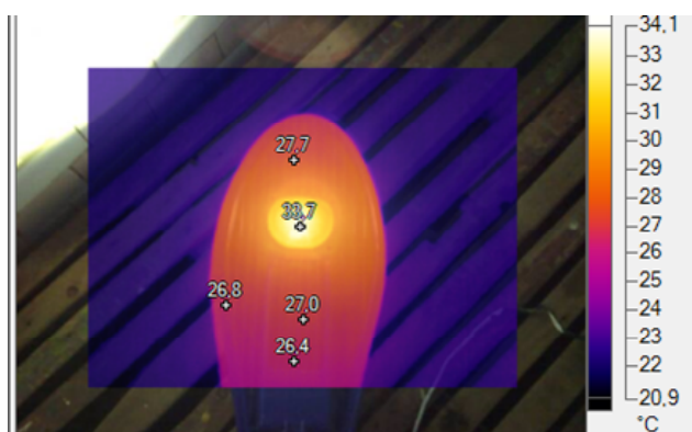
Рис. 1. Термограмма по определению температурных характеристик светильника
