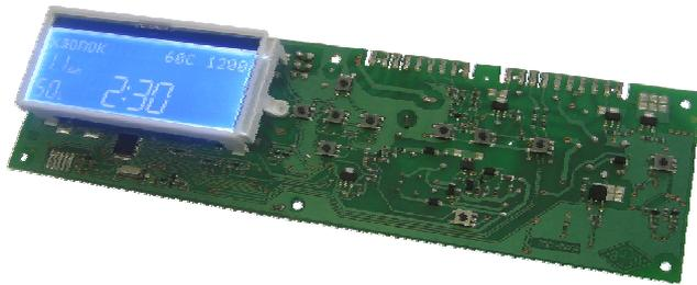
Блок электронный предназначен для управления работой электромеханических компонентов стиральной машины автоматической (СМА), выпускаемых ЗАО «Атлант» (г. Минск).
