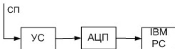
Блок-схема соединения функциональных системных модулей КРПЭС: СП - соединительные провода, УС - устройство согласования, АЦП - аналого-цифровой преобразователь.
