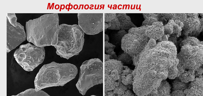
Исходный порошок После диффузионного борирования
