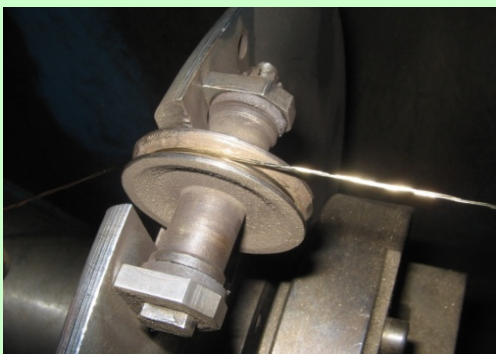
Новый роликовый узел машины свивки металлокорда
