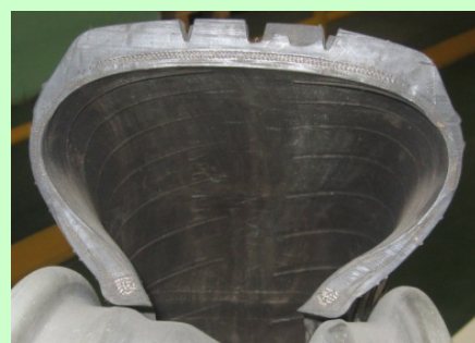
Поперечное сечение шины с металлокордом
