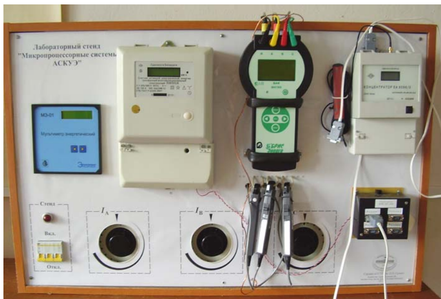
Рис. 2 Внешний вид лабораторного стенда «Микропроцессорные системы АСКУЭ»
