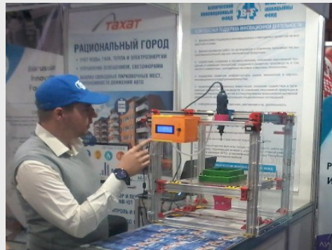
Фотополимерный LCD 3D-принтер на базе МФУ MultiCube-1
