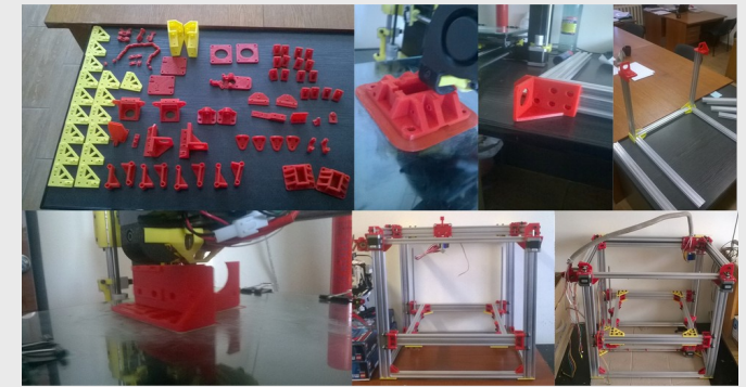
Элементы конструкции МФУ MultiCube
